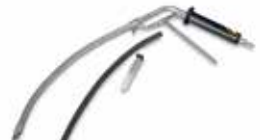
Testsonde for eksos fra personbil med bensinmotor (maksgrense 500 °C)
