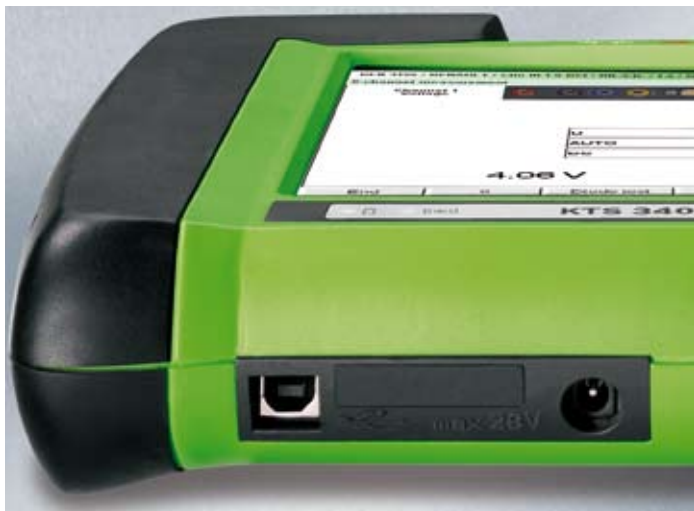
Tilkoblinger: USB for PC og skriver, kortplass og nettdrift
