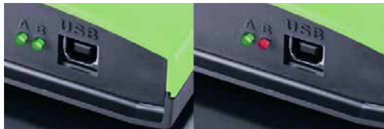
Tilstandsvisning pr. LED på KTS-kabinett
